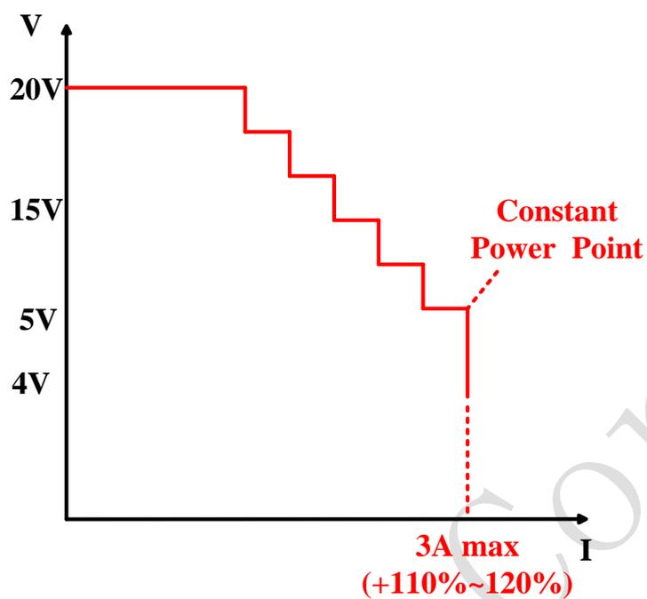
图 7. 恒功率的电压与电流
