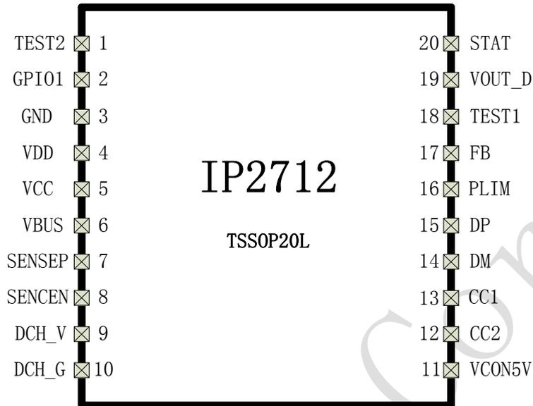
图 4. IP2712 引脚图 (顶面图)
