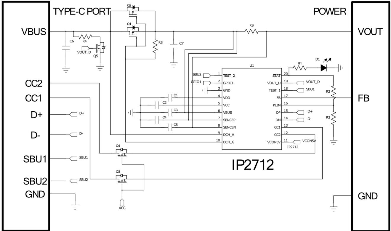
(注: Q3/Q4 用于防止适配器不工作时，由于 CC 状态不稳定导致设备对适配器放电)
